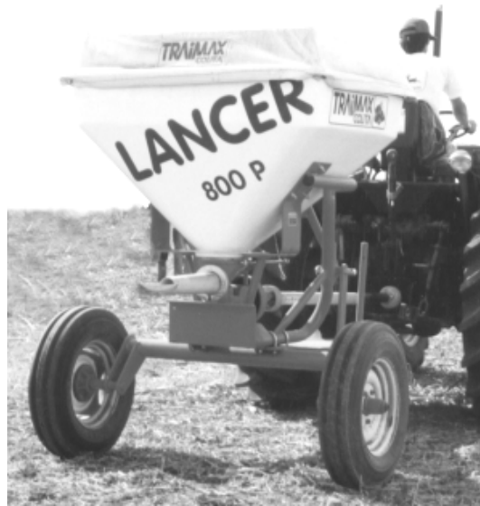
Figura 35. Fertilizadora centrífuga de péndulo o tubo oscilante
