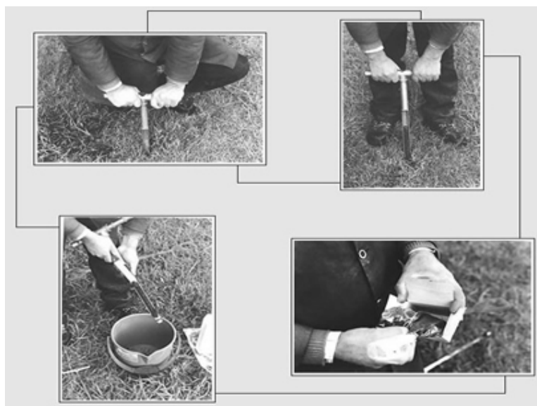
Figura 15. Muestreo de suelo con barreno para formar una muestra compuesta
