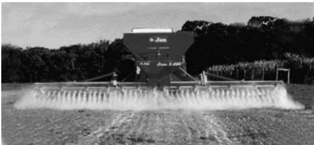
Figura 28. Aplicadora de enmiendas con botalón a tornillo sinfín
