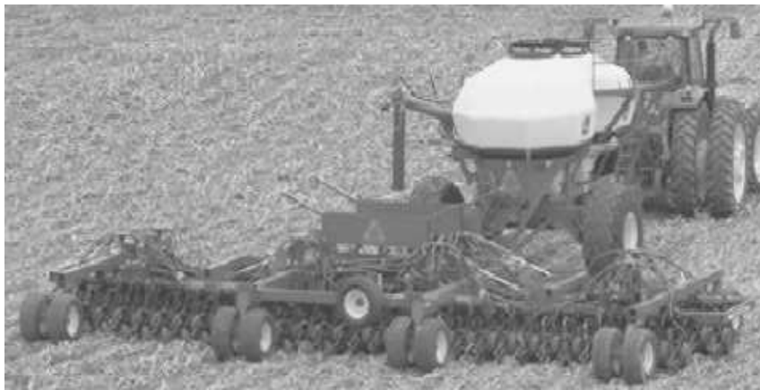
Figura 36. Fertilizadora con transporte neumático
