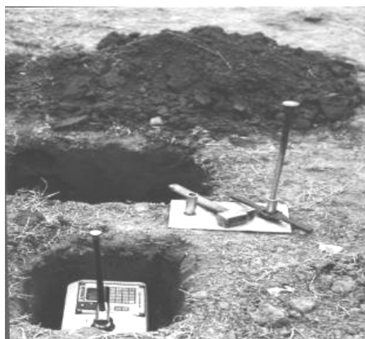
Figura 47. Determinación de densidad en profundidad
