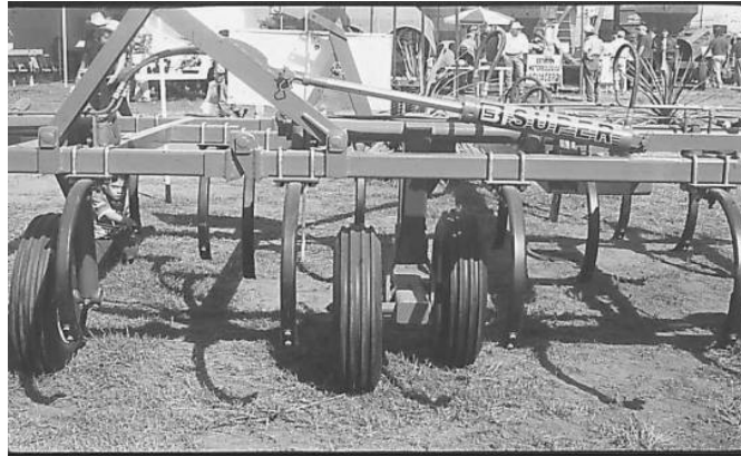
Figura 57. Vista posterior del escarificador, separación entre arcos y planos de acción
