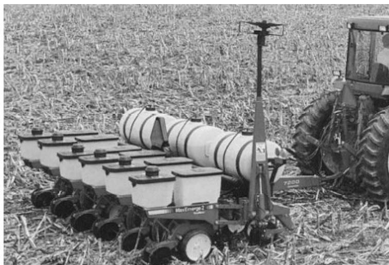
Figura 38. Sembradora con aplicación de fertilizante sólido y líquido
