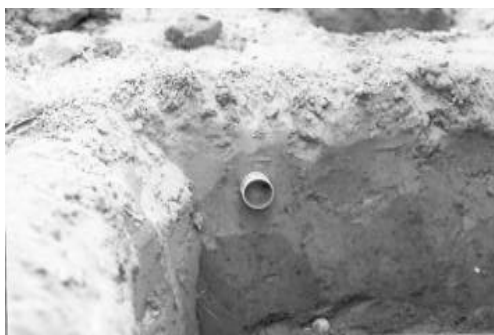
Figura 45. Determinación de densidad con cilindros
