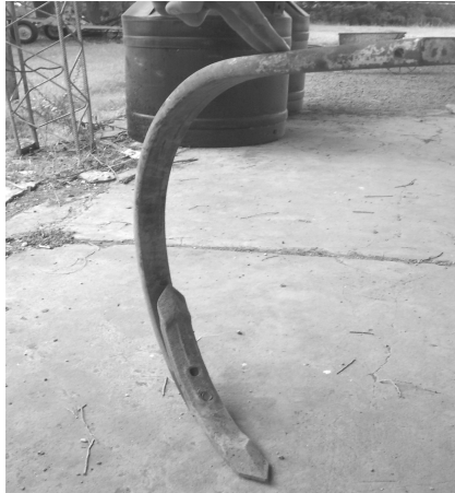
Figura 49. Arco flexible con reja convencional reforzada
