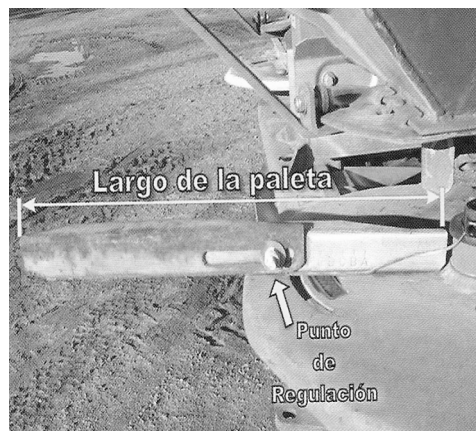
Figuras 33 y 34. Regulaciones de las paletas dosificadoras y su incidencia sobre el patrón de distribución (Fuente: R. Martinez Peck 2007)
