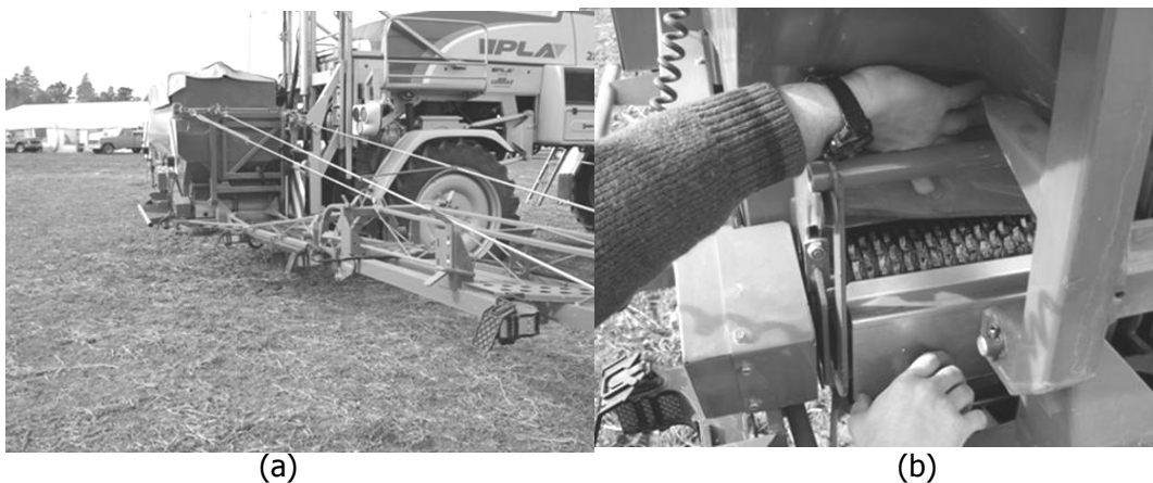
Figura 37. (a) fertilizadora con asistencia neumática con botalón y difusores (b) detalle del mecanismo dosificador en el fondo de la tolva
