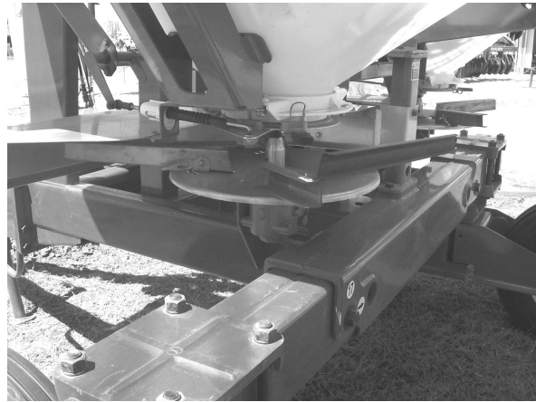
Figura 29. Fertilizadora centrífuga bidisco Figura 30. Detalle de los platos giratorios
