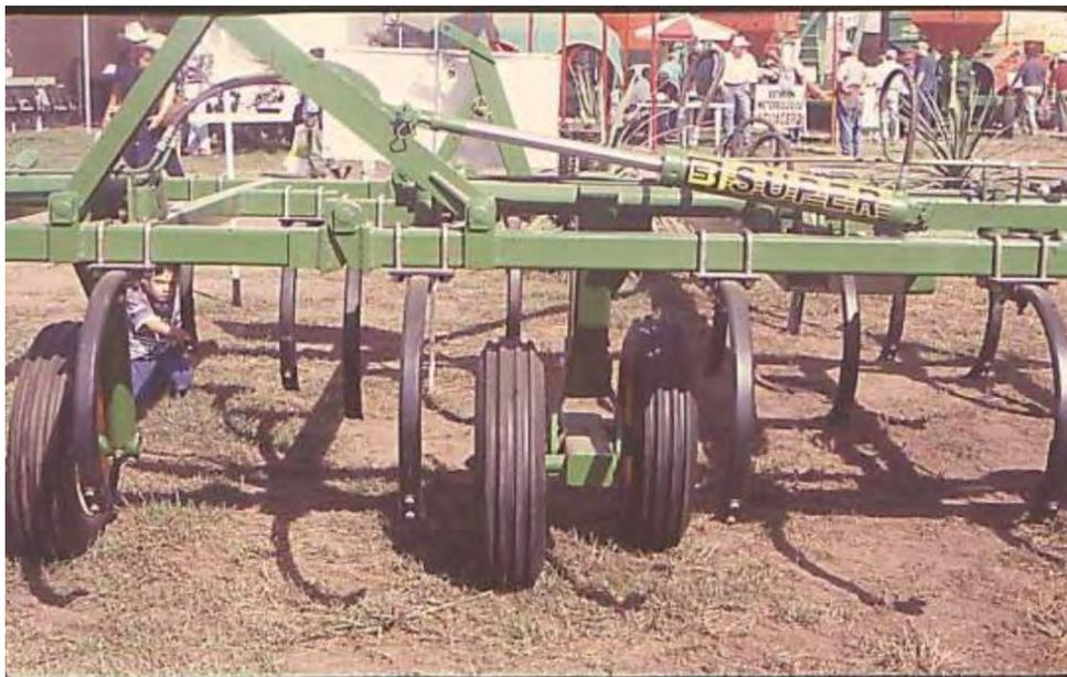
*Figura 80. Vista posterior del escarificador, separación entre arcos y planos de acción*
