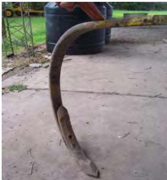
*Figura 74. Arco flexible con reja convencional reforzada*
