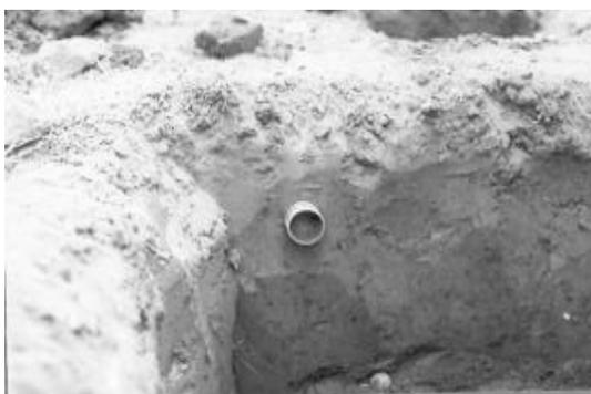
Figura 70. Determinación de densidad con cilindros
