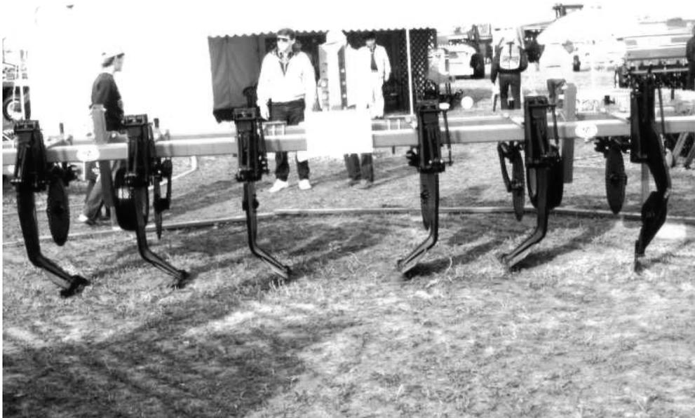
*Figura 93. Descompactador de montantes angulados laterales rectos de  $45^\circ$  con disposición simétrica del conjunto hacia el centro.*
