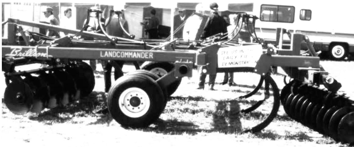
*Figura 86. Descompactador de montantes rígidos combinado con paquetes de discos delanteros y traseros*
