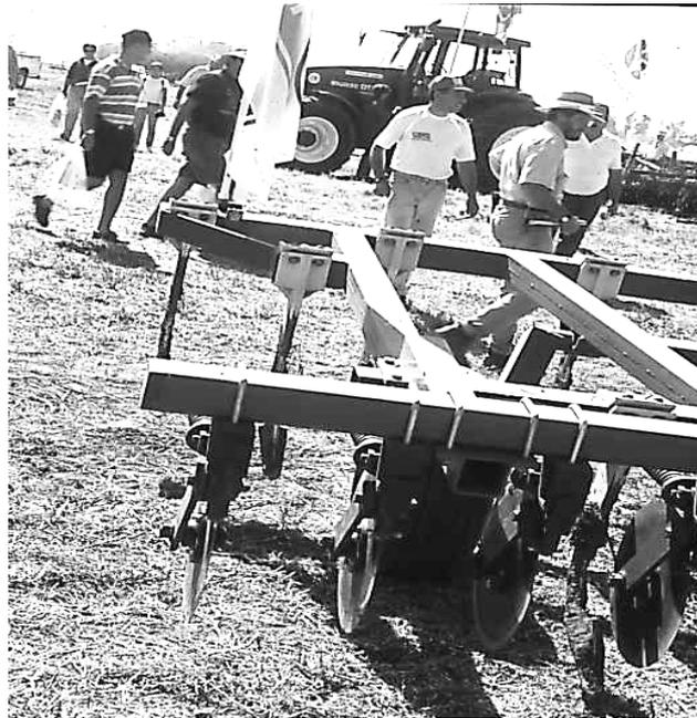
*Figura 96. Escarificador de montantes rígidos con cuchillas individuales en la línea de acción de las rejas dispuestas en la parte delantera del bastidor*
