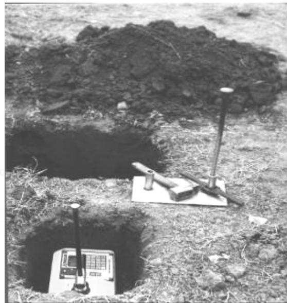
Figura 72. Determinación de densidad en profundidad
