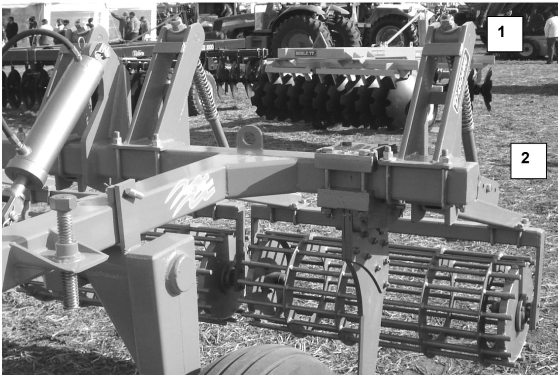
*Figura 91. Detalle de los rolos complementarios de un descompactador y la regulación de los mismos. 1) Regulación de la tensión; 2) Regulación de la posición*
