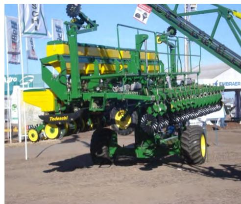
Figura 48. Sembradora-fertilizadora
