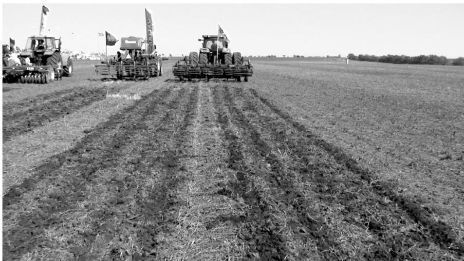
*Figura 90. Trabajo realizado por un descompactador de brazos angulados y rolos desterronadores sobre rastrojo de soja*
