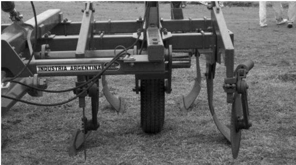
*Figura 92. Descompactador de montantes angulados curvos y configuración por pares hacia el centro.*
