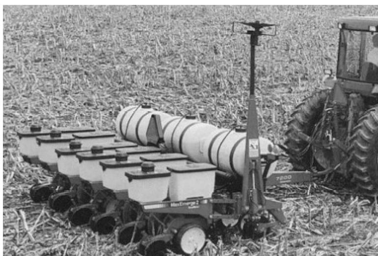
*Figura 63. Sembradora con aplicación de fertilizante sólido y líquido*
