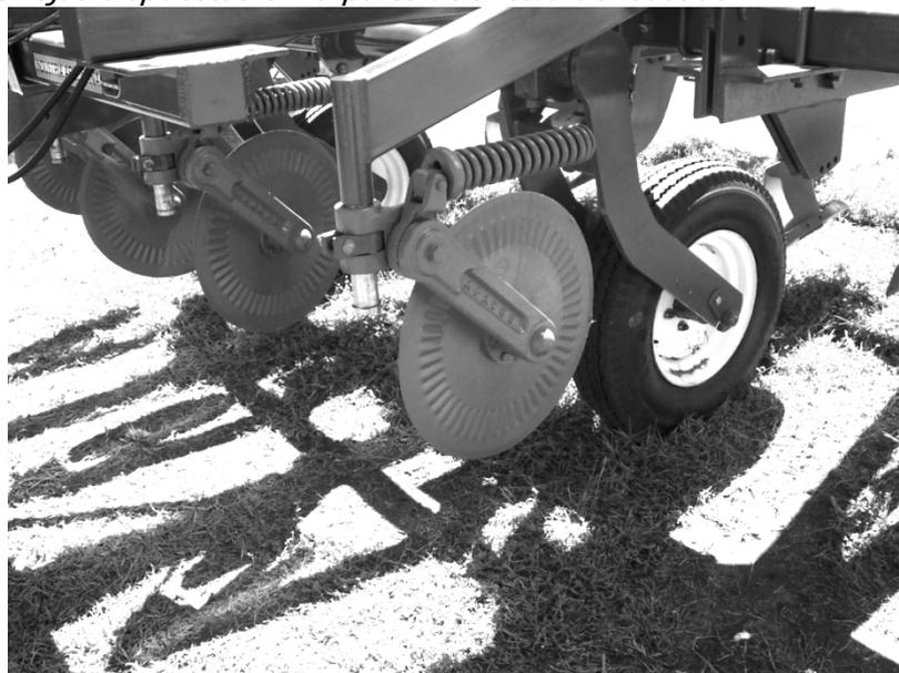
*Figura 97. Cuchillas circulares onduladas de filo liso, de montaje individual en la parte delantera de un descompactador de montantes angulados lateralmente y lámina curva*
