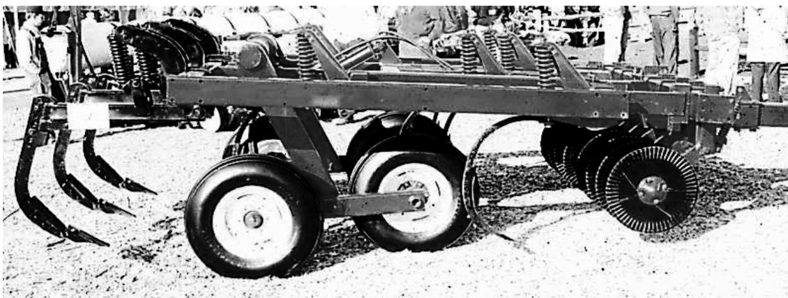
*Figura 85. Escarificador combinado con cuchillas circulares, cinceles de arcos flexibles y descompactadores rígidos*
