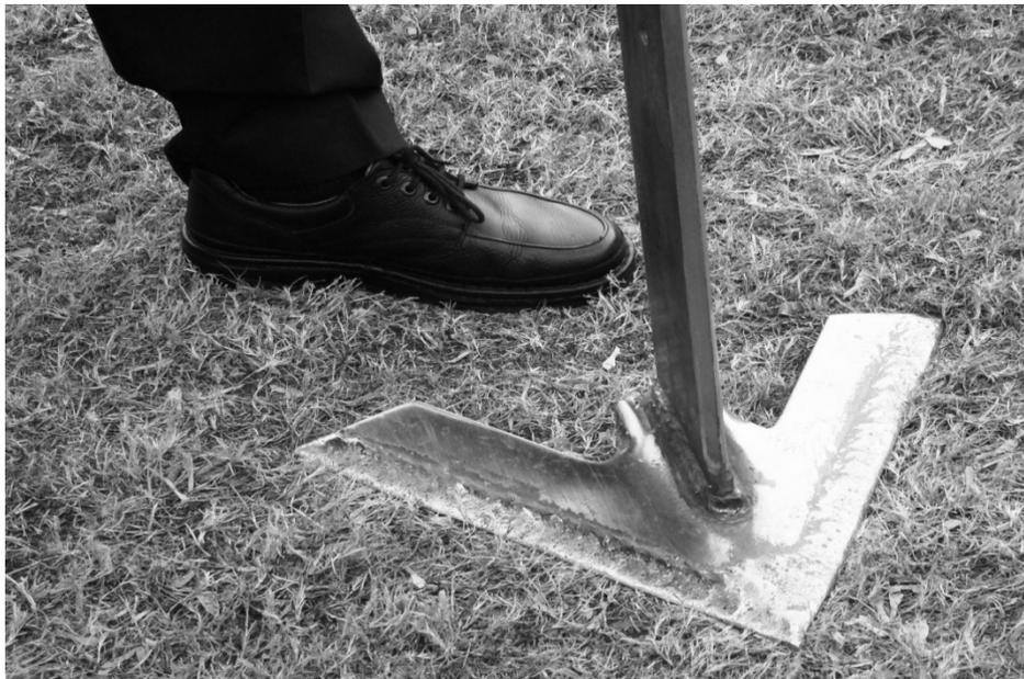
*Figura 95. Escardillo sub-superficial con rejas de 0,53 m de ancho*
