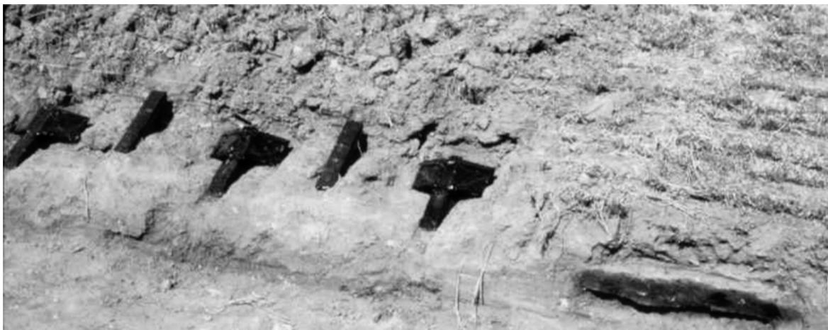
*Figura 88. a) rejas de descompactador convencionales y aladas. b) vista de un trabajo de descompactación con rejas combinadas en un mismo escarificador, roturando una capa compactada*
