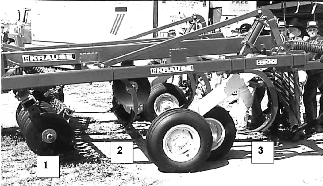
*Figura 87. Escarificador combinado de rastras de disco desencontrada (1), cinceles y rejas convencionales superficiales (2) y descompactadores rígidos con rejas convencionales (3)*
